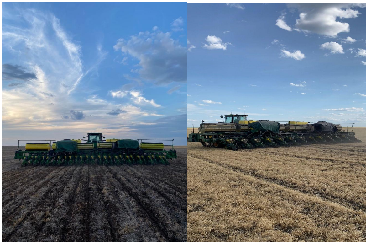
Figura 6 – Semeadora-adubadora 2126 John Deere semeando soja na Unidade de Produção Piratini.
