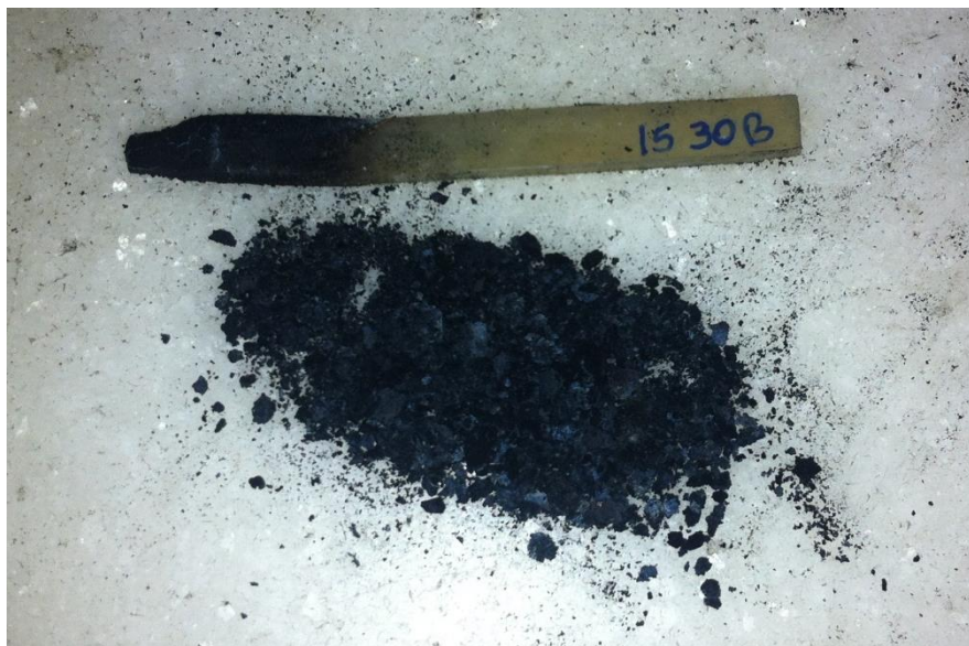
Figura 67. Amostra C30B pura/EVA após o teste de queima.
