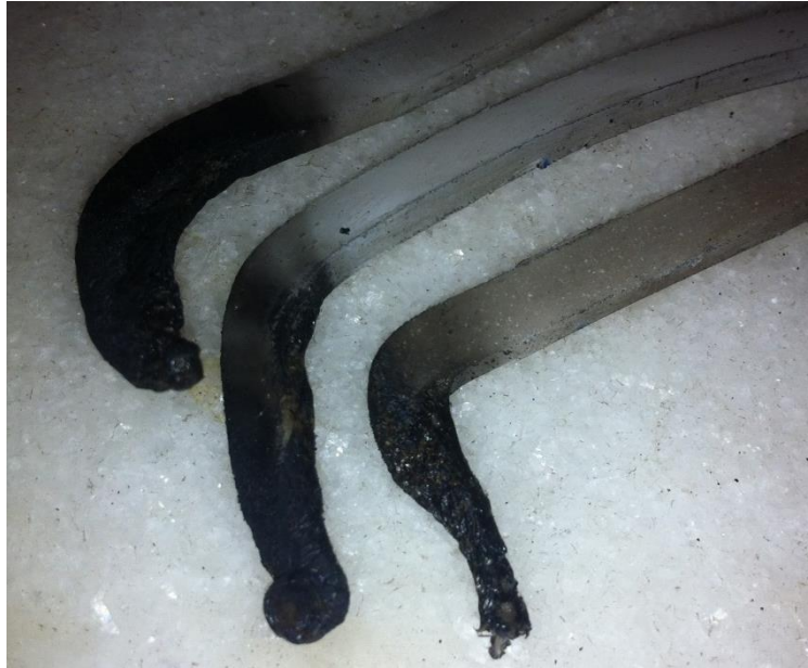
Figura 68. Amostras SiO 2 PO 2 /EVA, SiO 2 P 2 O 5 PO 2 /EVA e C30B PO 2 /EVA após teste de queima.
