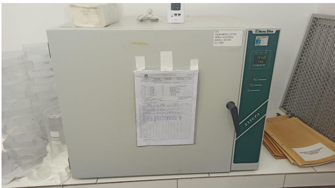
Figura 3. Estufa com circulação de ar quente usada para superação de dormência das sementes de arroz.
