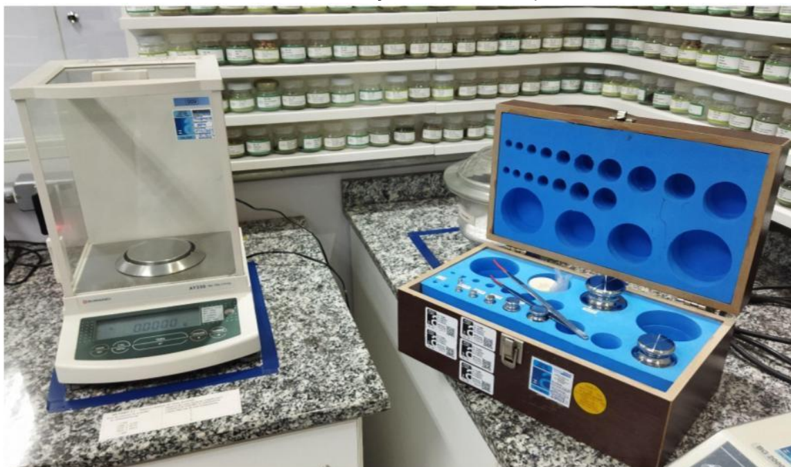
Figura 1 – À esquerda, balança analítica sendo conferida. À direita, instrumentação utilizada na conferência das balanças analíticas e de precisão.
