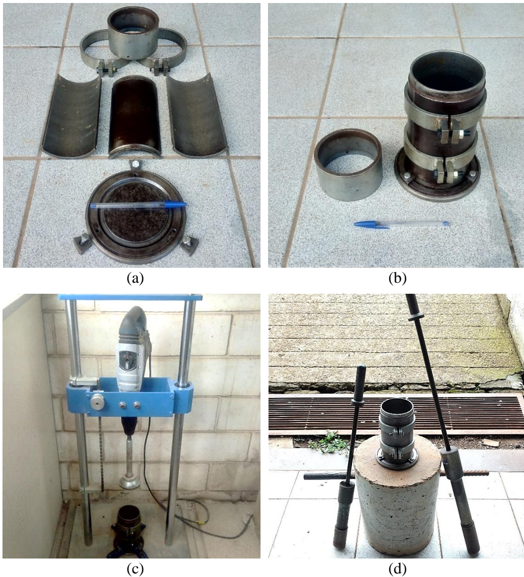
Figura 30 – Detalhes da moldagem dos CPs para os ensaios mecânicos: (a) peças do molde tripartido, (b) molde tripartido montado, (c) compactação vibratória com martelete e (d) compactação dinâmica com soquete
