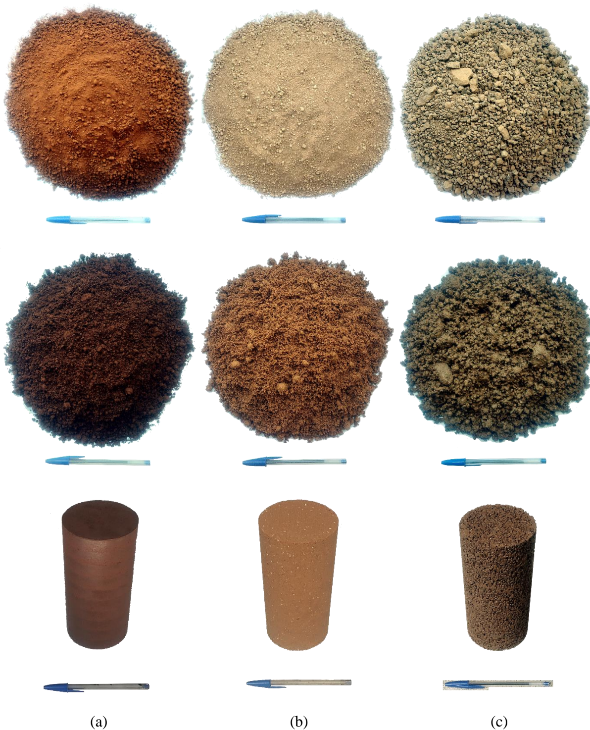
Figura 31 – Aspecto dos materiais nos diferentes estágios da moldagem: (a) AS, (b) SA e (c) SB
