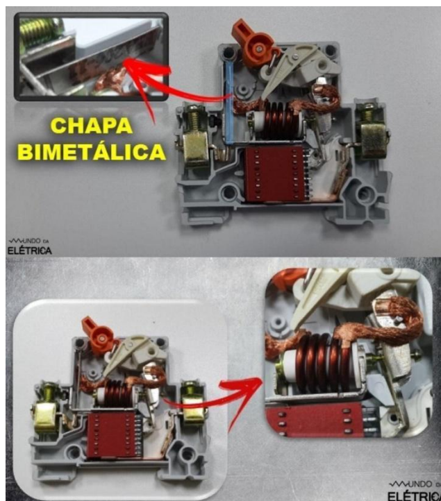
Figura 8 Disjuntor por dentro. Fonte: Mundo da Elétrica. Disponível em https://www.mundodaeletrica.com.br/disjuntor-termomagnético-como-funciona/
