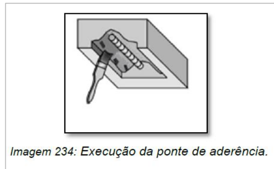
Figura 22 - Construção da ponte de aderência
