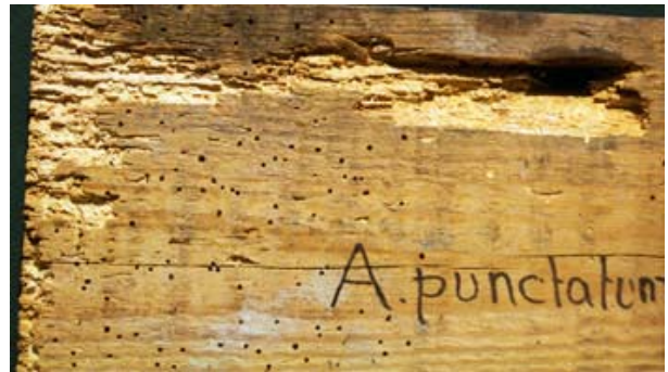
FIGURA 10 – Danos Causados pelo Anobium punctatum na Madeira. Fonte: COLEMAN, 2002.
