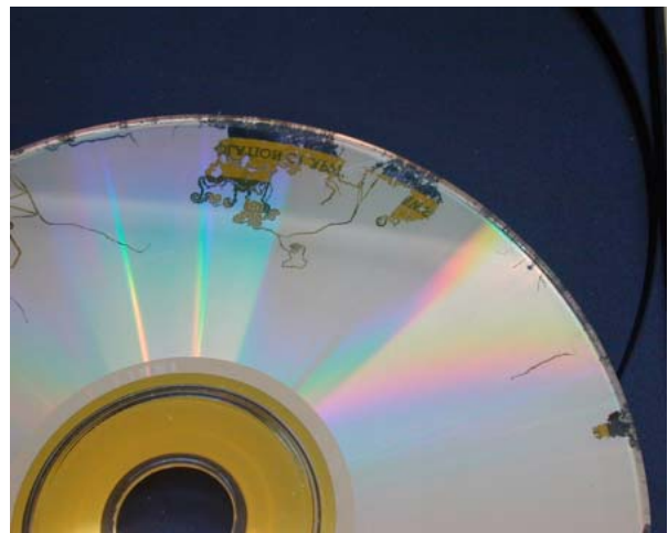
FIGURA 27 – CD Atacado por Fungo. Fonte: GARCIA-GUINEA ET AL., 2003
