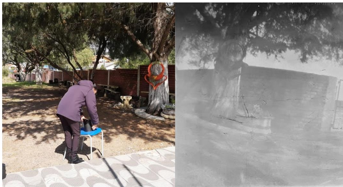
Figura 24 - Professora posicionando a câmera escura e imagem obtida ao revelar o filme de raio x.
