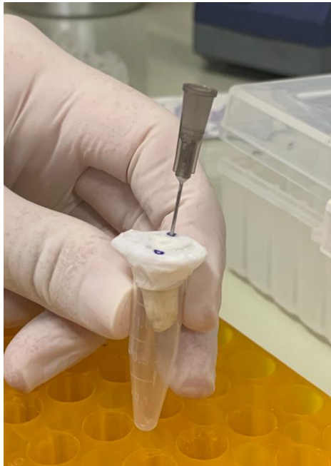
Figura 5: confecção de orifício central e laterais nos microtubos, para possibilitar inoculação e trocas de meio de crescimento.
