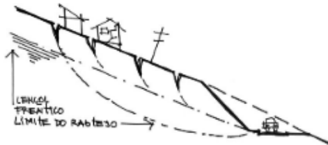
Figura 5 - Movimento de terra gravitacional do tipo rastejo.
