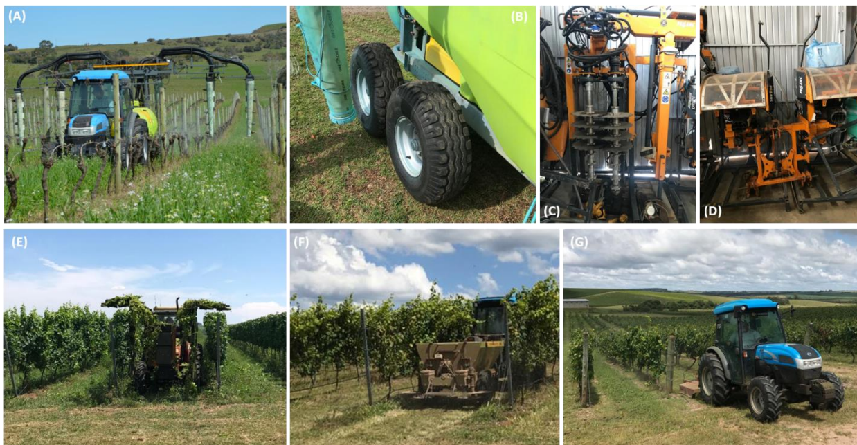
Figura 10. Pulverizador multifila Rocha Mittos (A), sistema tandem dos pulverizadores multifilas (B), pré-podadora, para uso na poda de limpeza (C), desfolhadora (D), despontadora (E), distribuidor de corretivo hidráulico (dois disco) (F) e roçadeira (G).
