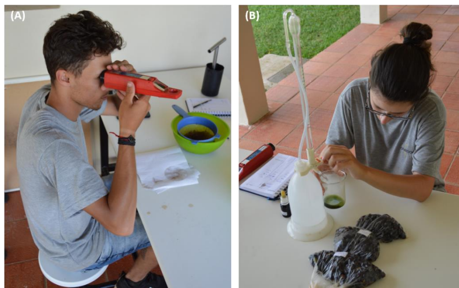
Figura 2. Determinação do álcool provável (Refratômetro sobre base de 16,83g/L) (A) e determinação da acidez titulável com azul de bromotimol e NaOH (0,1 mol/L) (B).
