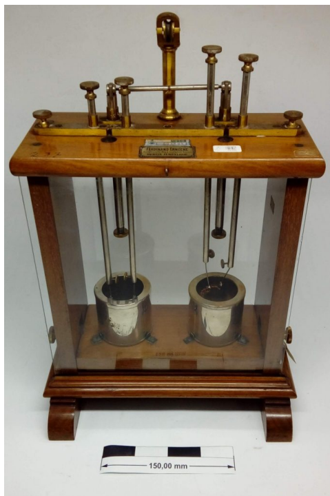
Figura 27 – AMLEF064: Calorímetro Doppel. Fabricado por Ferdinand Ernecke, proveniente da Alemanha.
