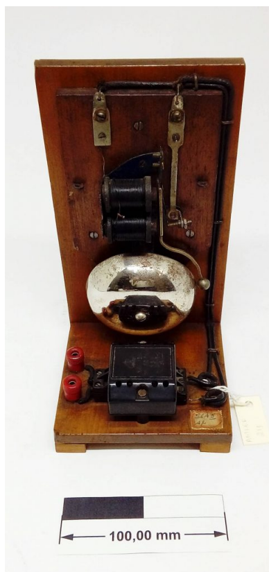
Figura 31 – AMLEF211: Campainha elétrica. Instrumento de demonstração e estudo.
