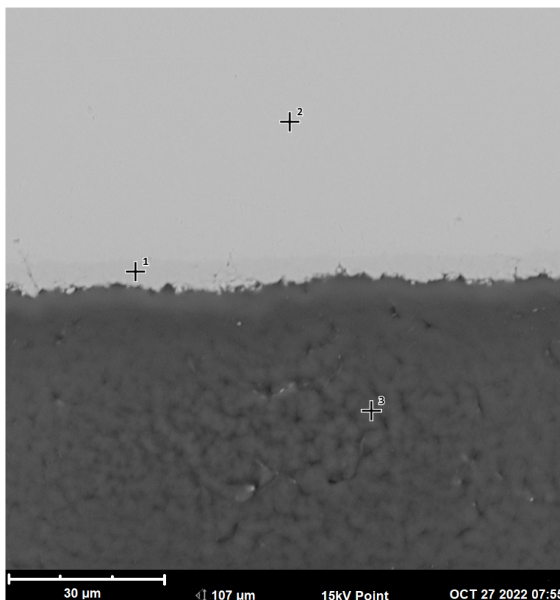
Figura 26 – Imagem MEV/EDS da seção transversal da amostra 6Cr com ampliação de 2500x. Os pontos 1, 2 e 3 indicam os locais onde foram feitas medidas com EDX a fim de identificar o filme de Cr, o substrato, e a resina.
