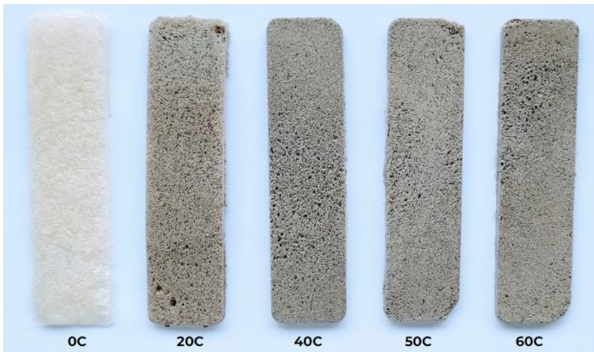
Figura 4.5. Fotografia da vista superior das espumas à base de amido, produzidas com concentração de CCA de 0 % (0C), 20 % (20C), 40 % (40C), 50 % (50C) e 60 % (60C)
