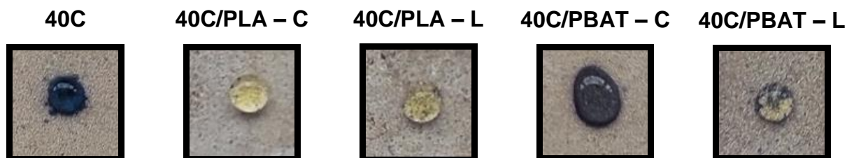
Figura 4.28. Fotografias das espumas para análise da efetividade do revestimento polimérico com PLA e PBAT – teste do iodo.
