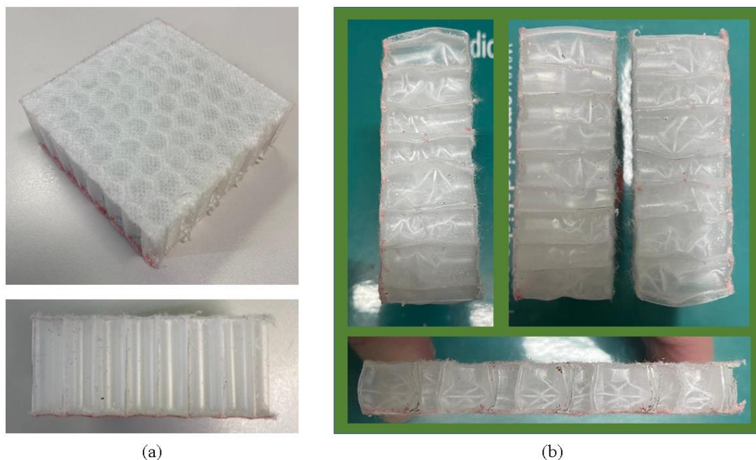
Figura 24 - Núcleos (a) não-deformados e (b) deformados em ensaio de compressão.
