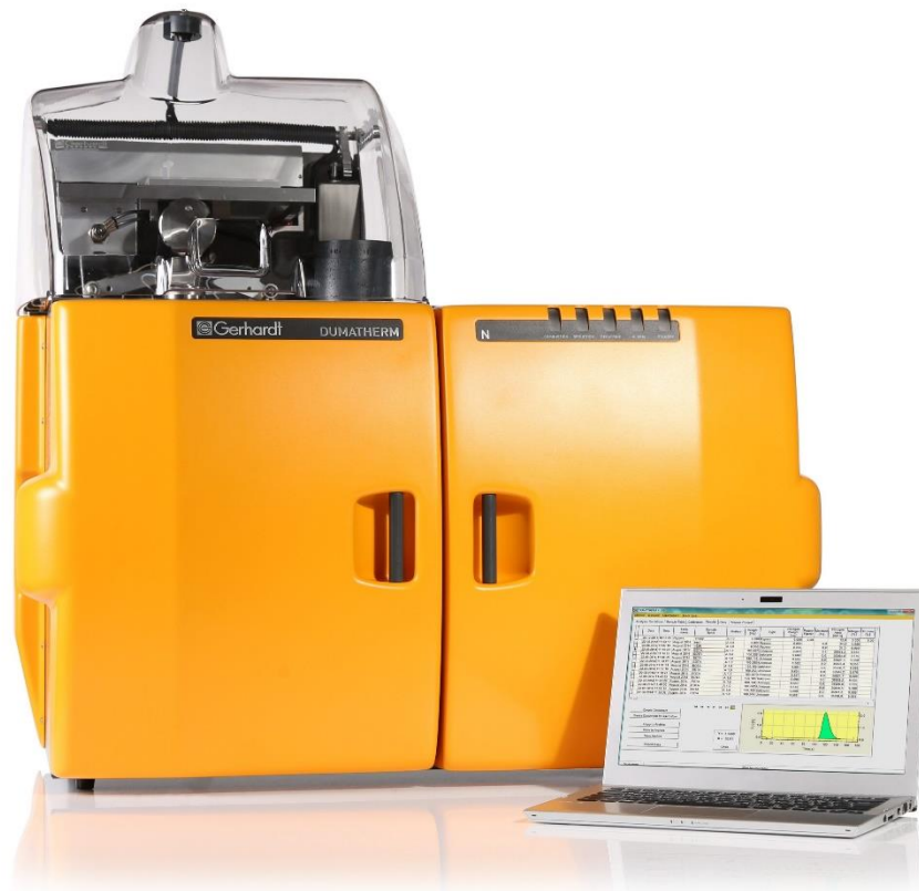
Figura 4 – Esquema geral de funcionamento do Dumatherm DT Ar/He para determinação de proteínas (método Dumas)
