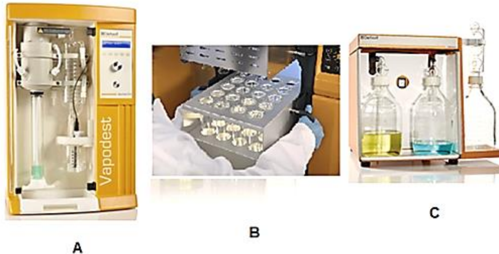
Figura 5 – Sistema de destilação e titulação (A) e digestão (B e C) para determinação do teor de proteínas – equipamentos Gerhardt (método Kjeldahl)
