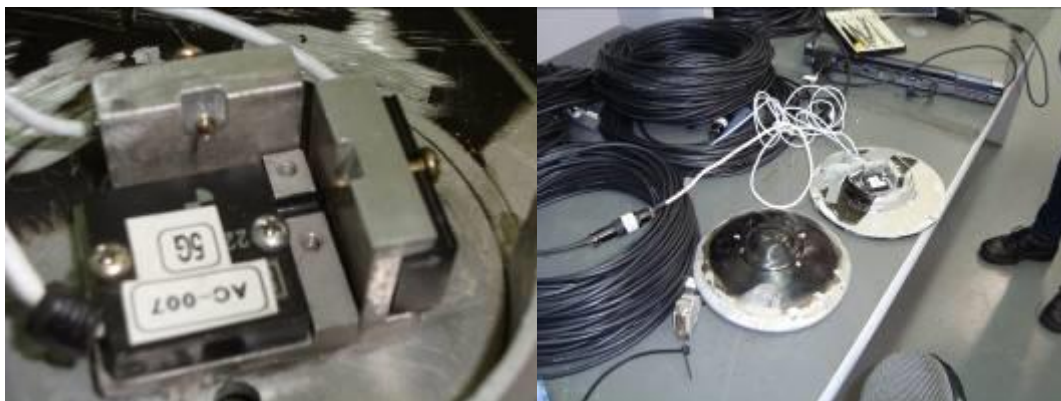
Figura 26 – fixação do acelerômetro no seat pad fixado no assento do motorista.
