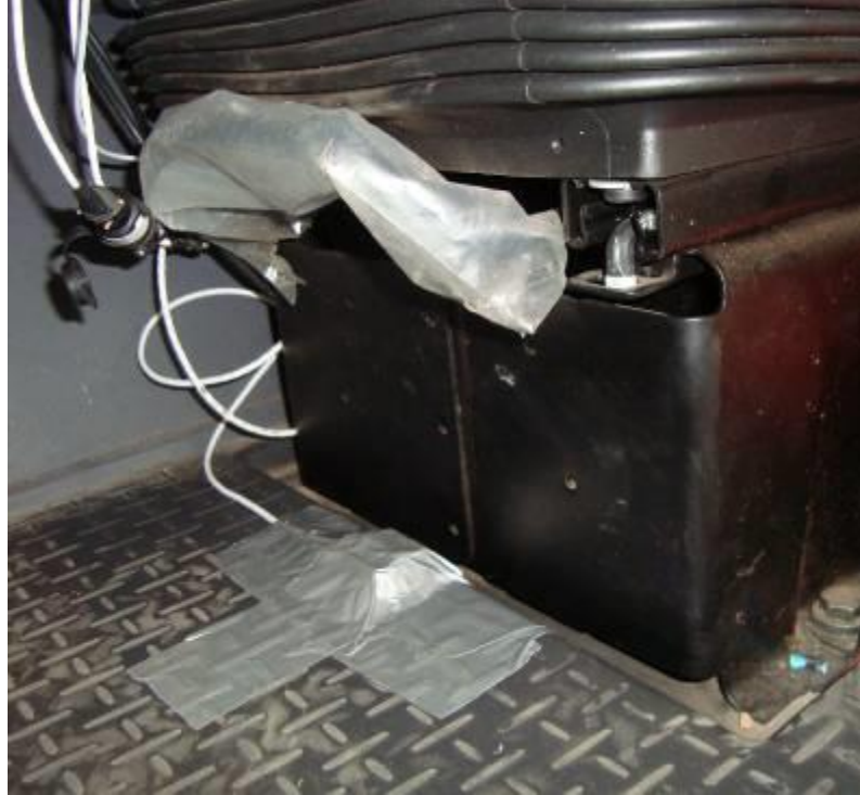
Figura 24– Fixação do acelerômetro no piso do caminhão.
