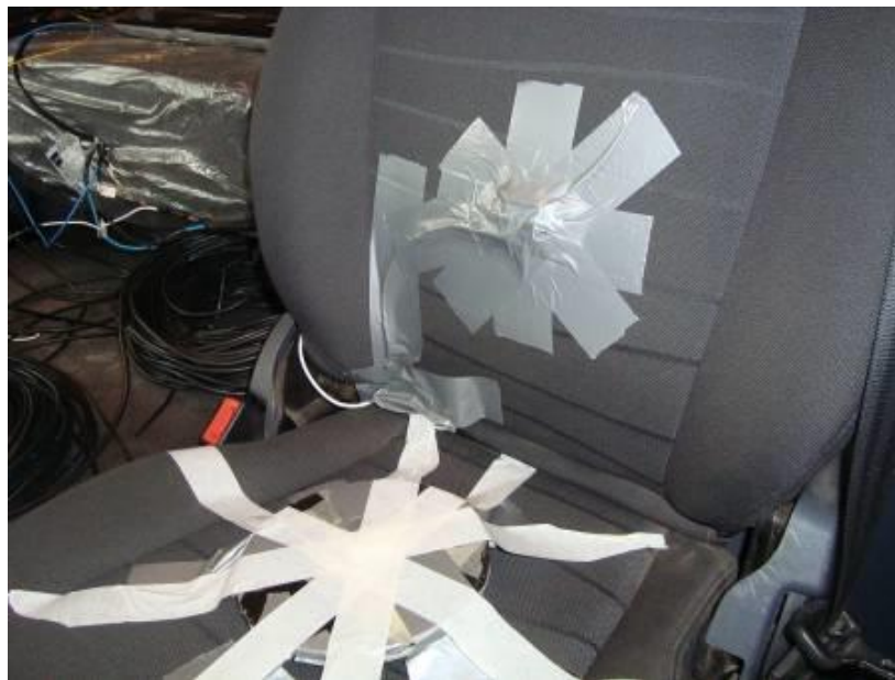
Figura 25 – Fixação do acelerômetro no assento e nas costas do motorista
