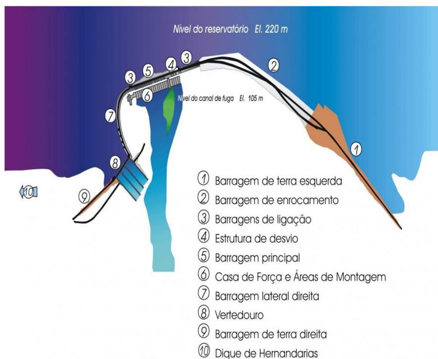
Figura 3-9 – Localização das estruturas da UHE de Itaipu
