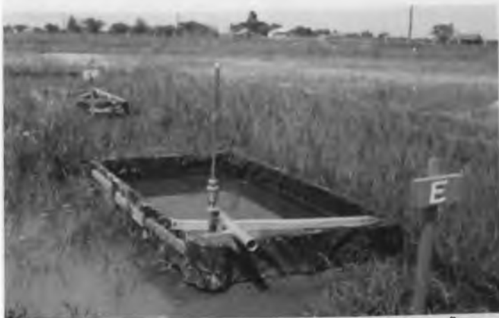
FOTO 7 - CAIXAS DE EVAPORAÇÃO E EVAPORAÇÃO + PERCOLAÇÃO
