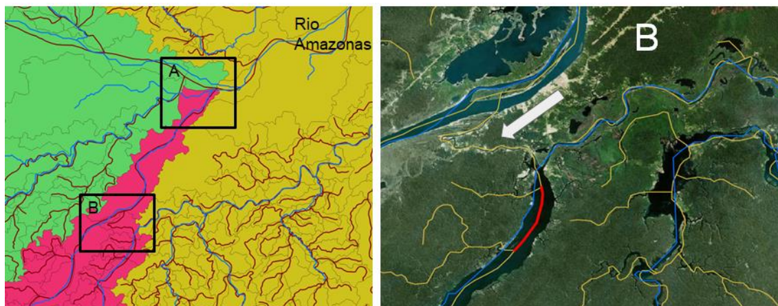
Figura 5. Região da foz do rio Madeira (A) em que é notada a presença de conexões laterais (B). A rede BHO está em cores vermelho (esquerda) e amarelo (direita) enquanto a rede do MGB-AS está em azul. As cores das sub-bacias (verde, rosa e amarelo) estão relacionadas à ottocodificação nível 2 da Bacia Amazônica.
