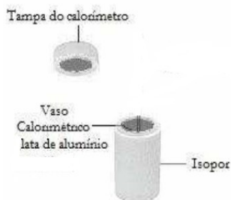
Figura 20- Esquema de montagem do calorímetro.
