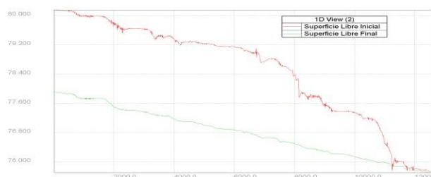
Figura 6.- Perfil longitudinal de la superficie libre en el tramo de río Bermejo modelado
