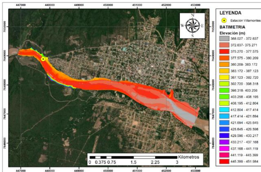
Figura 5.- Batimetría Implementada en el Modelo Delft3D a partir del Modelo de Elevación Digital
