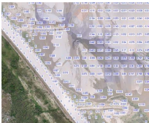
Figura 5.- Resultados de simulación. Sedimentación entre espigones.
