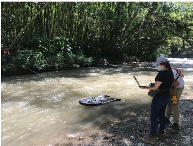
Figura 3. Estación La Bretaña – Sección de aforo con ADCP 20/09/2021
