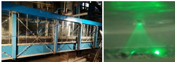
Figura 3. – Canal de alta pendiente en el LMF I – Campus Nord y hoja laser usada en PTV
