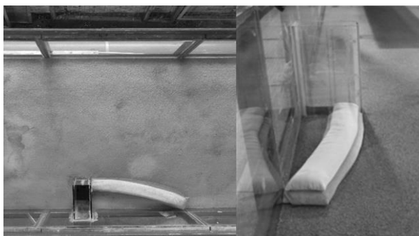
Figura 1.- Conformación de los muros ensayados
