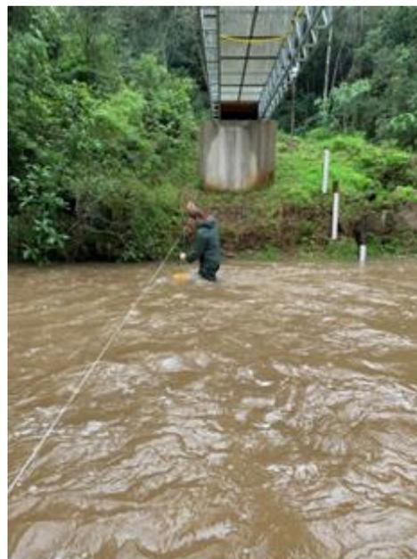
Figura 1.- Coleta manual de amostra de sedimento em suspensão com US DH-48.
