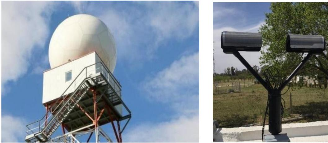
**Figura 2.-** Radar Meteorológico RMA1 (izquierda). Disdrómetro óptico Parsivel2 (derecha).
