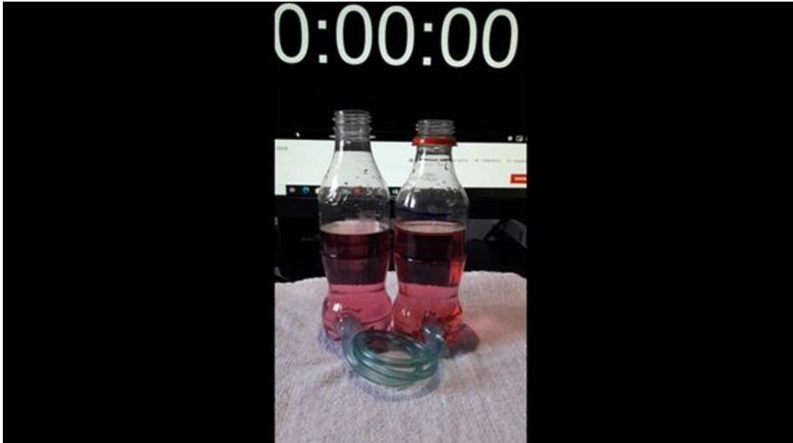
**Figura 8.** Depósitos conectados con una manguera con tres círculos , diámetro 3mm.
