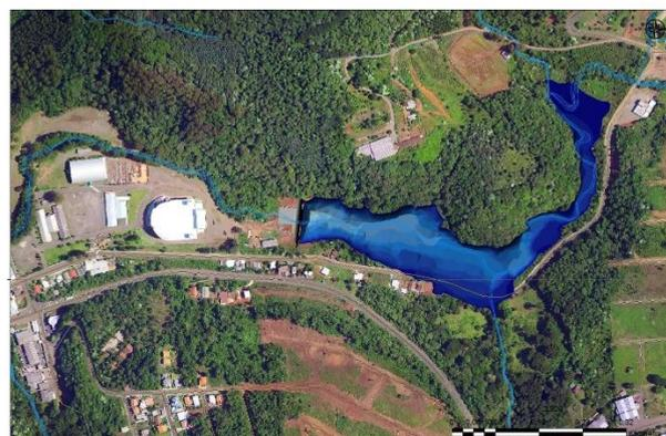
**Figura 3** – Modelo numérico do terreno somente da área inundável da barragem principal.
