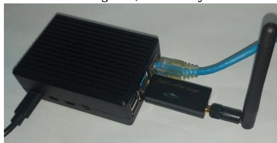
Figura 23 – Coordenador Zigbee, Gateway e Servidor da aplicação.
