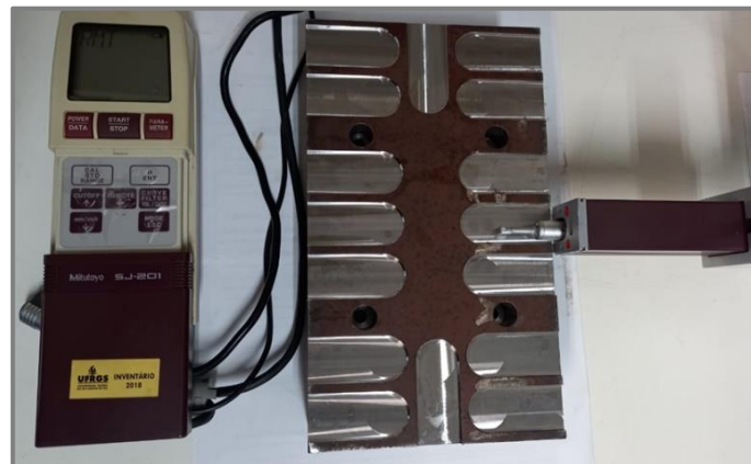
Figura 3.7 – Operação de medição realizada no corpo de prova
