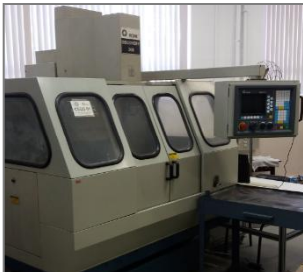
Figura 3.3 – Centro de usinagem Romi Discovery 308
