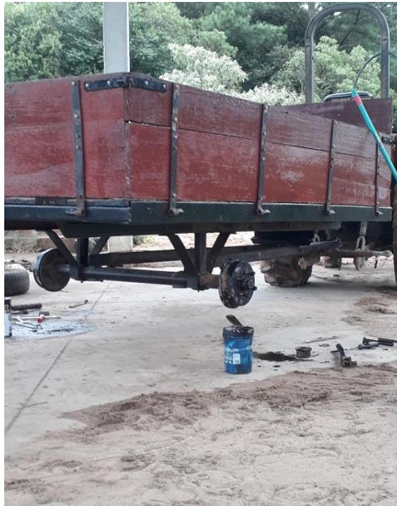
Figura10. Recuperação do reboque onde foi refeita a carroceria de madeira e posterior pintura da mesma, conserto dos cubos de roda, e pintura antioxidante do chassi. (Fonte: Marcelo Coli Pedroso).
