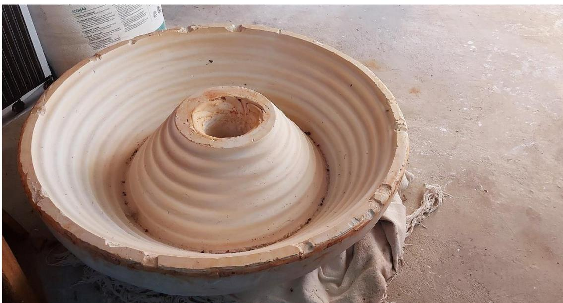
**Foto 11:** Molde em gesso para peça também em gesso. Molde semelhante àquele utilizado para a produção de Elementos ornamentais autônomos. **Fonte:** Foto do autor.
