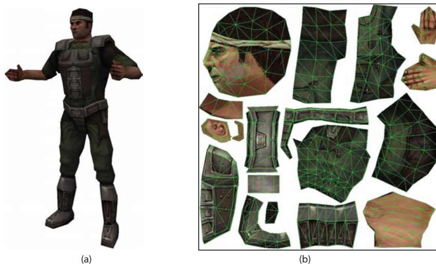
Figura 2.1: Mapeamento de textura. No item (a) podemos ver uma malha de triângulos em 3-D. Já no item (b) podemos ver o mapeamento dessa malha sobre uma textura. Com base nesse mapeamento podemos definir uma cor para cada ponto sobre a superfície da malha 3-D como sendo a cor correspondente no espaço paramétrico.
