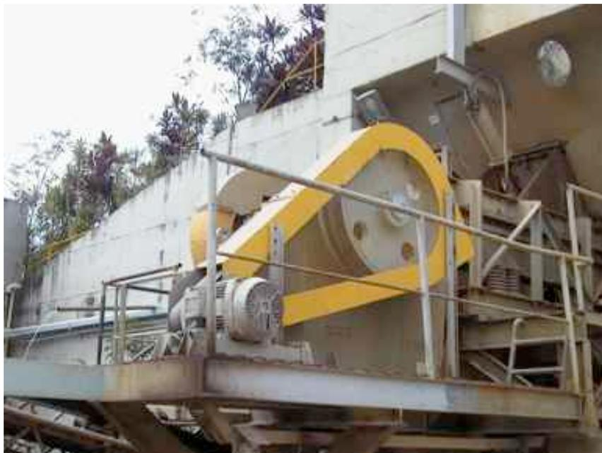
Figura 4-7: Britador de Mandíbulas de um Eixo – Cia Nitro Química
