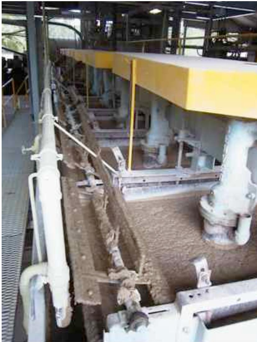
Figura 4-15: Células de Flotação – Cia Nitro Química
