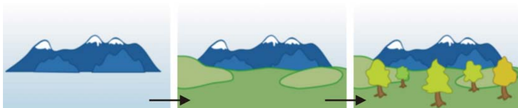
Figura 2.4: Representação do Algoritmo do Pintor . As montanhas distantes são pintadas por primeiro, seguido pelo terreno e finalmente pelos objetos mais próximos do observador, as árvores.
