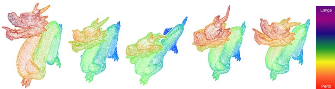
Figura 3.1: Cinco quadros da animação ilustrando o resultado da aplicação do operador operador HPR baseado em Octree para uma nuvem de pontos dinâmica do modelo Dragon . Este método é mais eficiente que o operador original e gera imagens com baixo percentual de erro.
