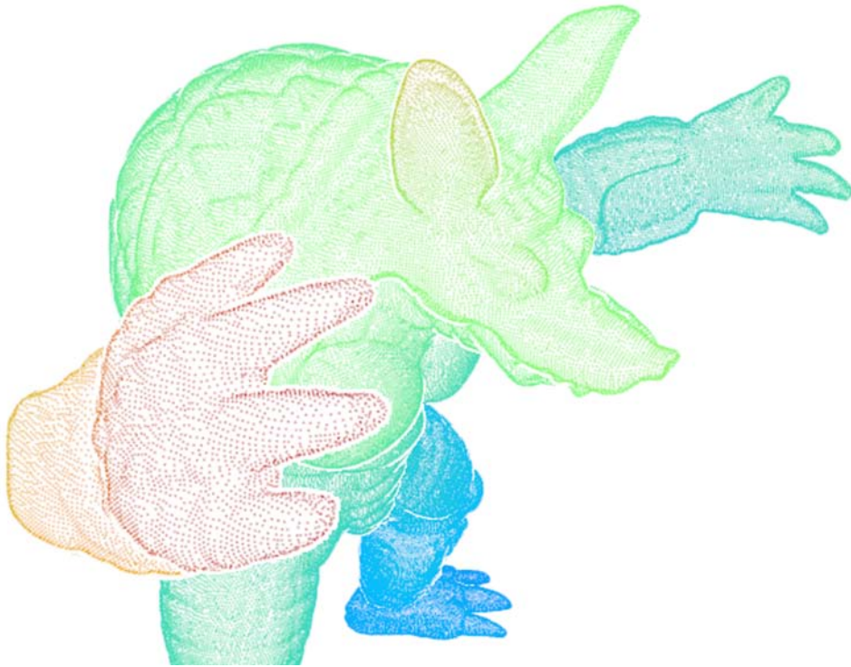
Figura C.2: Armadillo (172974 pontos, 203.80 FPS a 640 x 480).
