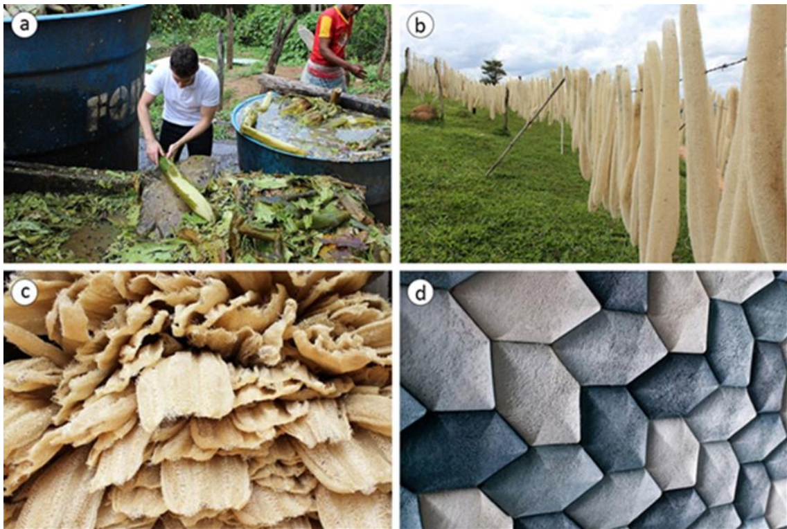
Figura 21: Processo de beneficiamento da Luffa cylindrica : a) extração da casca; b) processo de secagem ao ar livre; c) corte padronizado da matéria-prima; d) azulejos acústicos para revestimento de áreas internas.
