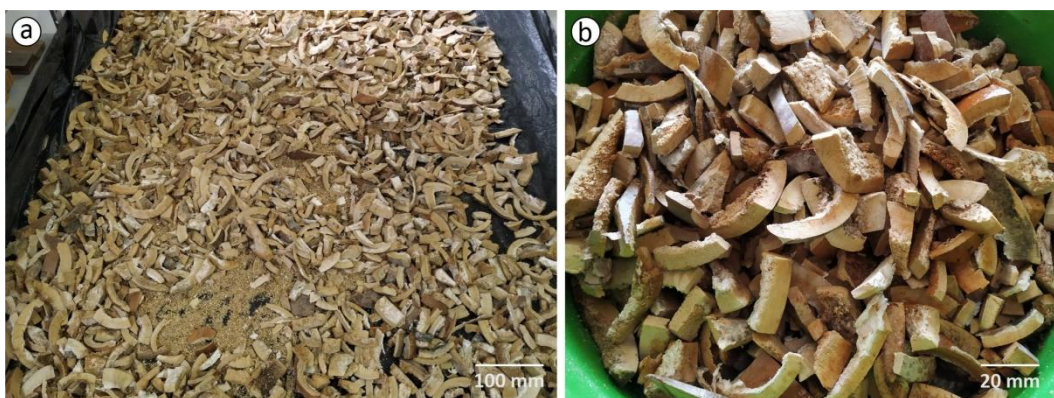
Figura 71: Separação e secagem das partículas: a) Secagem dos resíduos em ambiente controlado; b) Resíduos preparados para a trituração.
