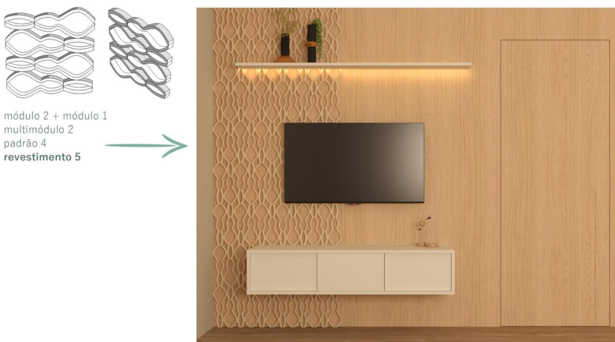
Figura 64: Revestimento 5 aplicado em painel.
