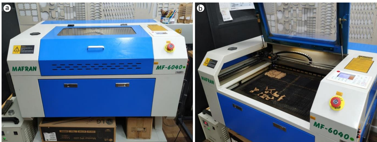
Figura 86: Máquina de corte e gravação a laser utilizada para os testes: a) Parte externa da máquina; b) Parte interna com detalhe da mesa de trabalho.
