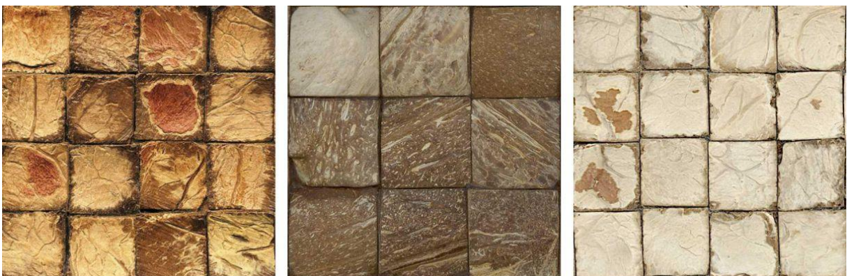
Figura 37: Revestimentos de pastilhas da casca do coco, montagem por adesão da parte posterior das pastilhas sobre uma base plana.
