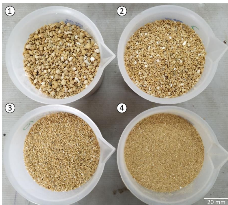
Figura 72: Partículas de porongo após peneiramento: 1) 10 mesh; 2) 16 mesh; 3) 30 mesh; 4) Pó.
