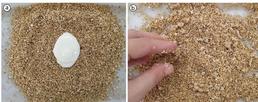
Figura 78: Mistura dos materiais: a) Matriz de amido e glicerol sobre as partículas; b) Mistura manual.
