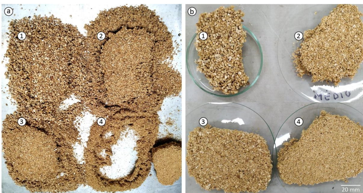
Figura 75: Painéis de partículas de porongo com resina ureia-formaldeído: a) Fraca adesão entre as partículas e o adesivo; b) Painéis removidos da chapa metálica. 1) Partículas de 10 mesh; 2) 16 mesh; 3) 30 mesh; 4) Pó do porongo.
