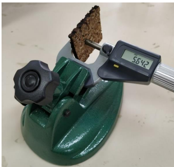
Figura 98: Equipamento utilizado para a medição da espessura dos painéis.
