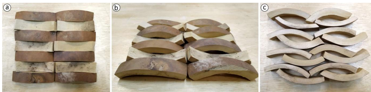
Figura 52: Estudos de composições com o módulo 1, corte de seção transversal: a) Padrão de listras com diferentes cores; b) Detalhe do volume da composição; c) Padrão com o desenho do semicírculo.
