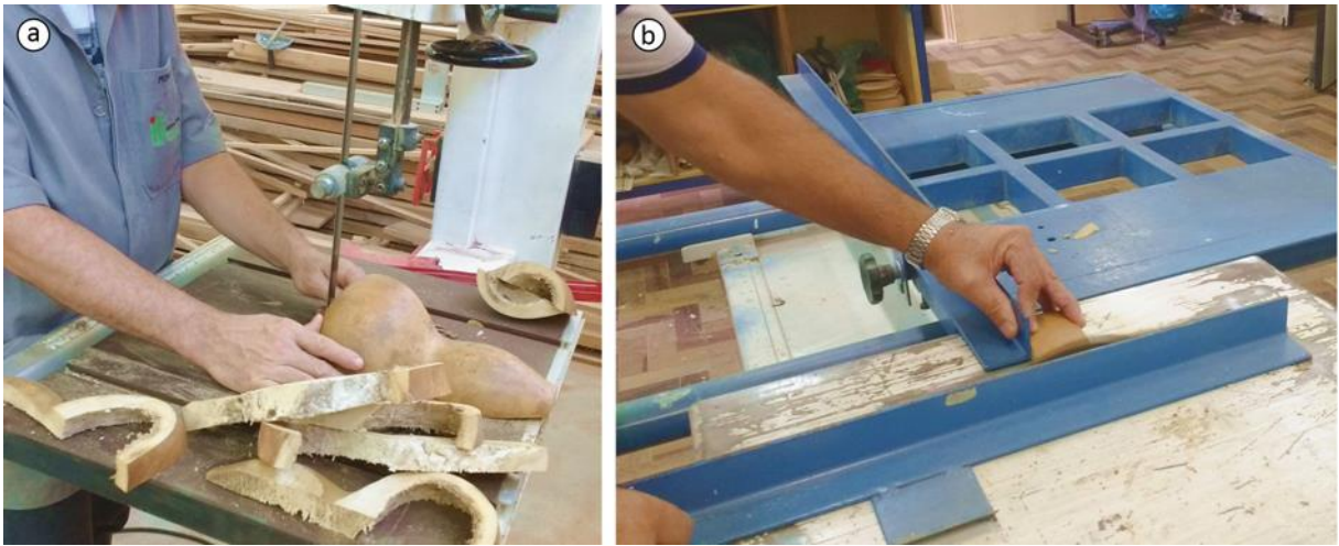
Figura 34: Corte dos perfis de porongo: a) Serra de fita; b) Serra esquadrejadeira.
