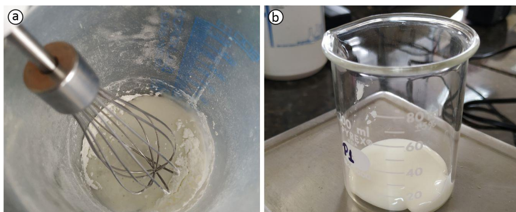
Figura 77: Preparo da matriz: a) Batedeira manual; b) Mistura de amido e glicerol.
