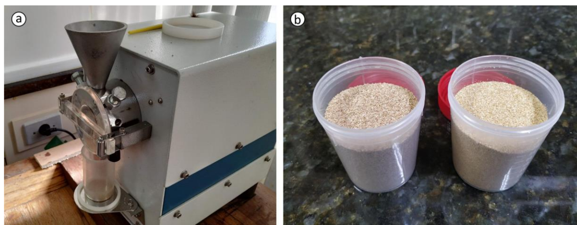
Figura 65: Preparo das amostras: a) Moinho de facas Willey; b) Amostras peneiradas.
