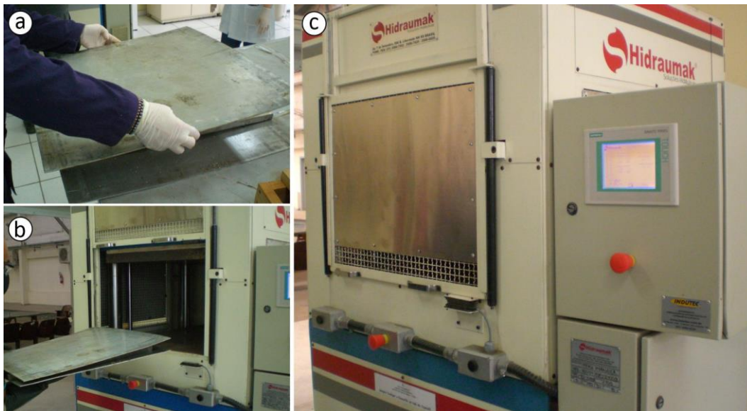
Figura 70: Prensagem: a) Chapa sobre os colchões de partículas; b) Painéis dentro da prensa; c) Vista externa da prensa hidráulica fechada.
