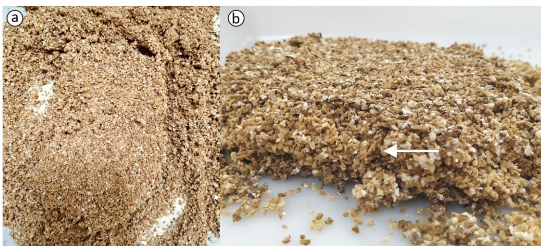
Figura 76: Adesão entre as partículas dos painéis: a) Superfície do painel, com adesão mais visível; b) Interior do painel com adesão mais fraca.
