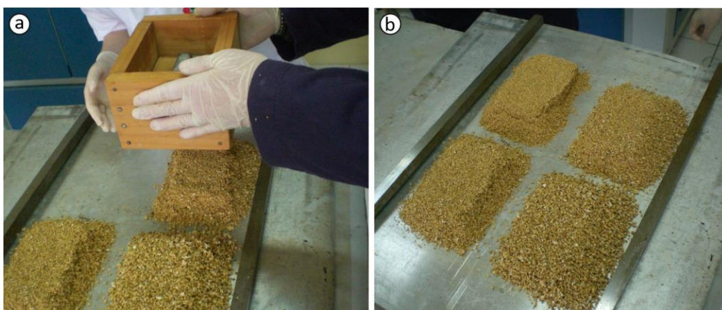
Figura 74: Montagem dos colchões de partículas: a) Colocação das partículas na caixa formadora; b) Colchões de partículas sobre a chapa, entre os afastadores.
