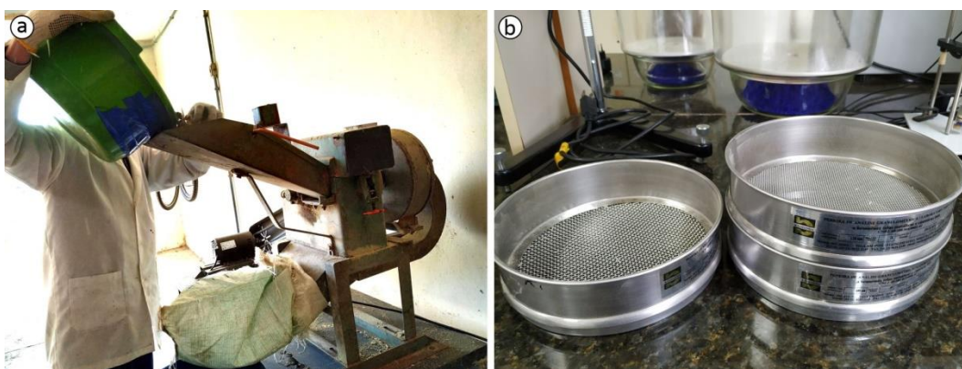
Figura 68: Trituração e peneiramento: a) Moinho de martelo; b) Peneiras granulométricas.
