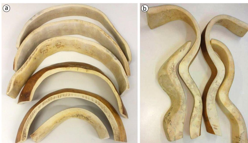
Figura 46: Cortes de seções selecionados para os revestimentos modulares: a) Semicírculo; b) Orgânico.
