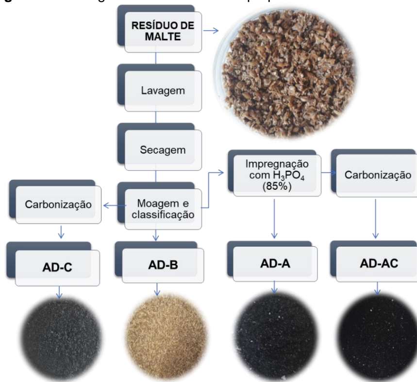
Figura 8 – Fluxograma com as rotas de preparo de cada adsorvente.
