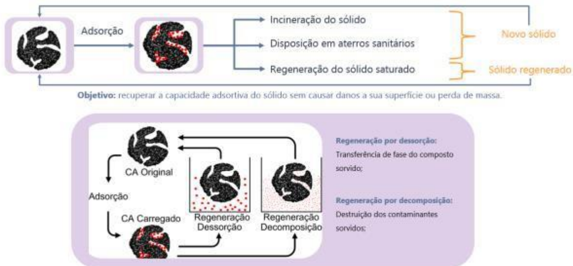
Figura 3: Representação do ciclo de adsorção e regeneração do carvão ativado e sua possível destinação
