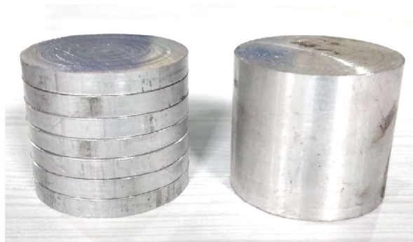
Figura 14 - Geratrizes utilizadas no processo de forjamento com reaproveitamento de sucata (esquerda) e forjamento convencional (direita).
