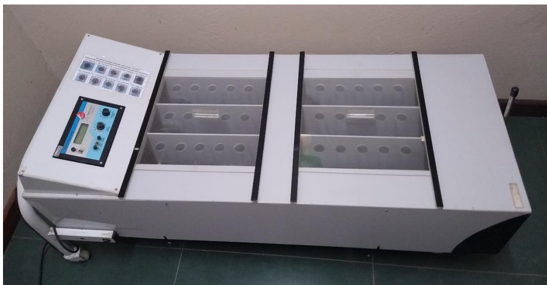
Figura 7: Imagem da esteira ergométrica adaptada para ratos Insight ® , na qual os animais executaram o treino locomotor.
