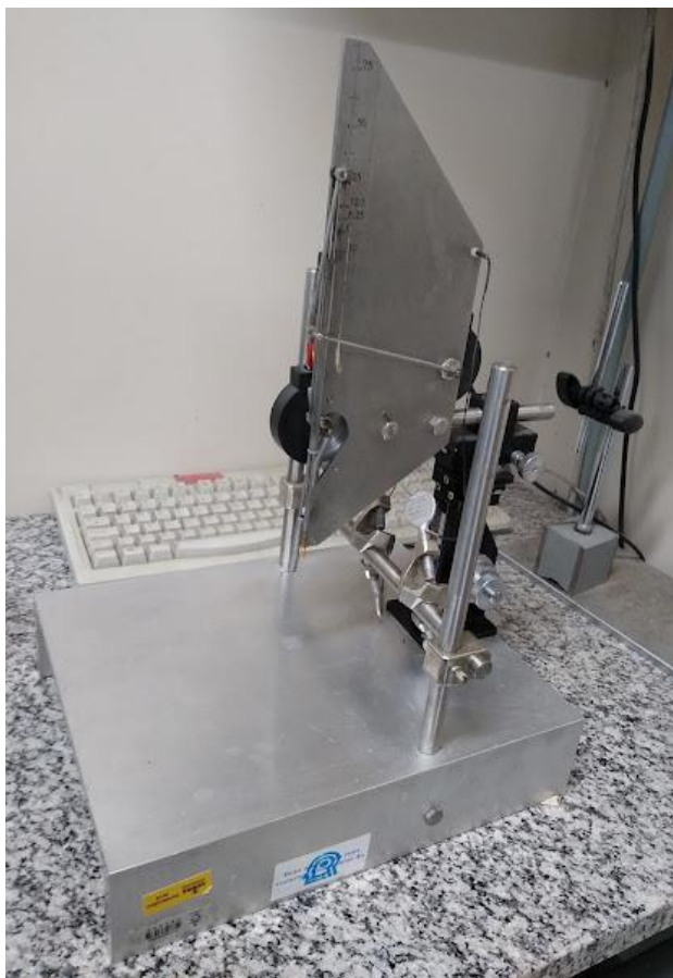
Figura 6: Imagem do equipamento New York University Impactor (NYU Impactor) , utilizado para a indução do modelo experimental de lesão medular por contusão em ratos.
