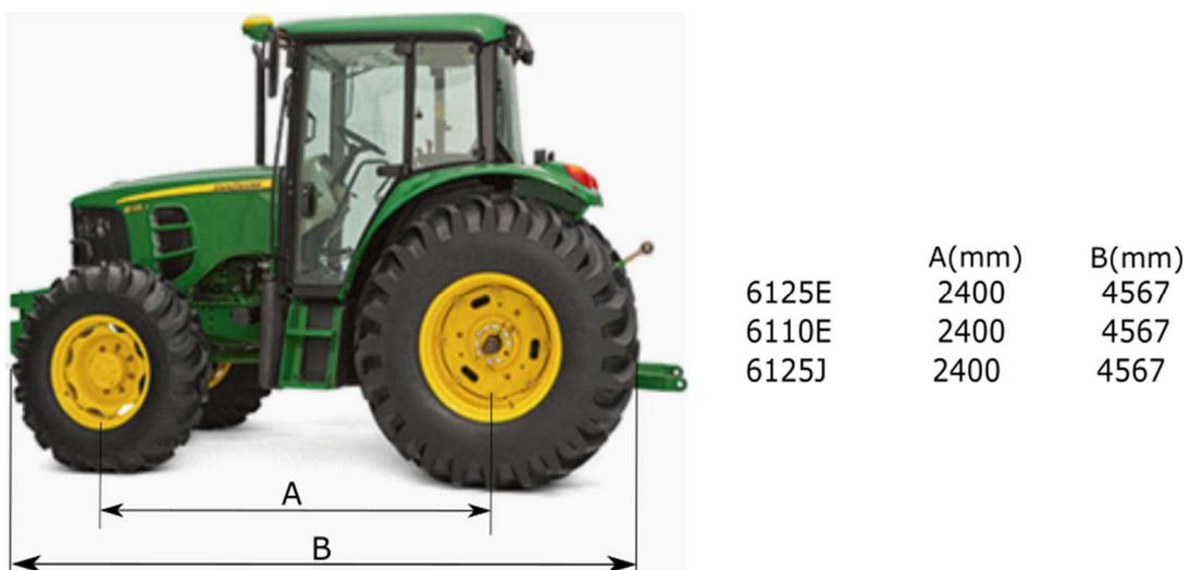
Figura 5 - Trator John Deere 6125J cabinado seu comprimento e entre-eixos.
