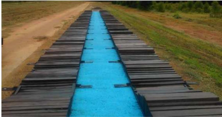
Figura 4 - Pista padronizada rugosa de 35m para ensaio de vibração segundo NBR ISO 5008(2015).
