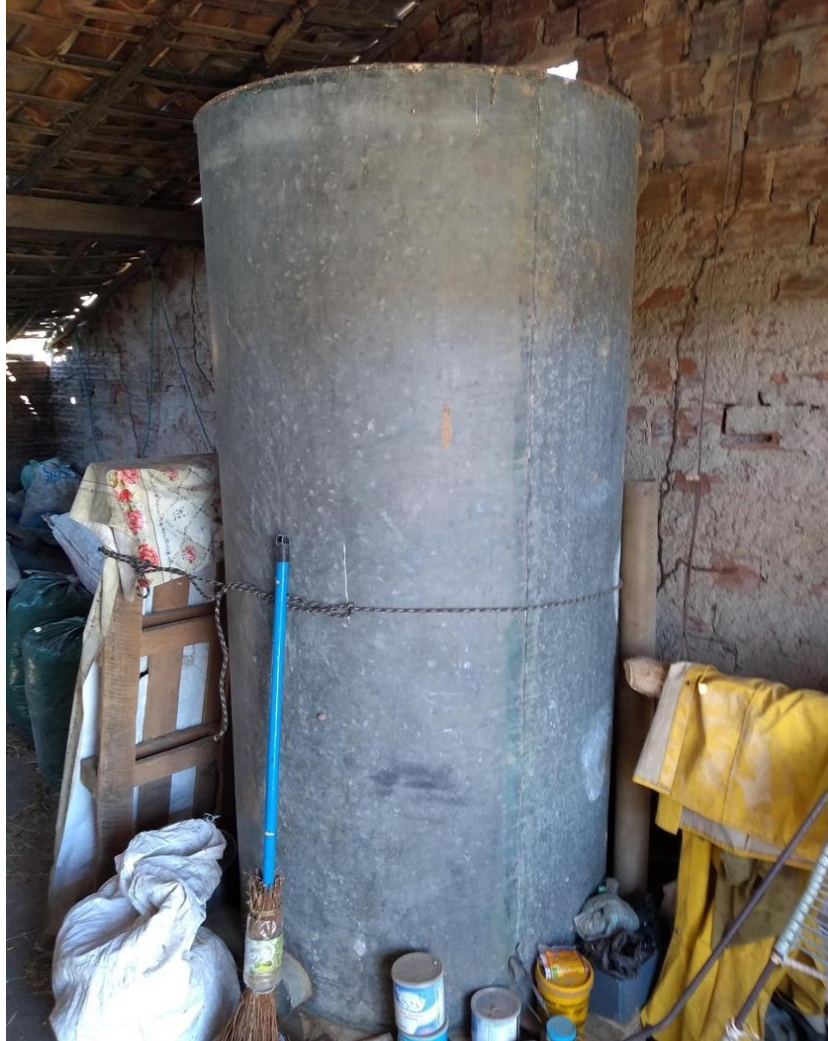
Figura 16 - Recipiente de zinco, também chamado de silo, utilizado para armazenar grãos
