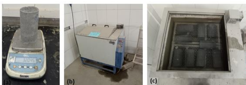
Figura 16 - Etapas de realização do ensaio de absorção e índice de vazios
