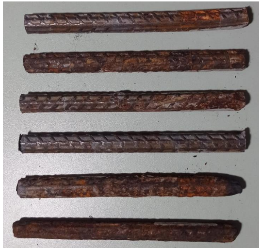
Figura 26 - Barras após a remoção do interior do concreto
