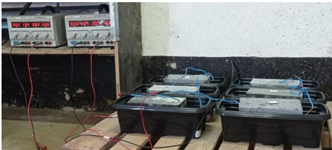
Figura 25 - Ensaio de corrosão acelerada por imersão modificada realizado
