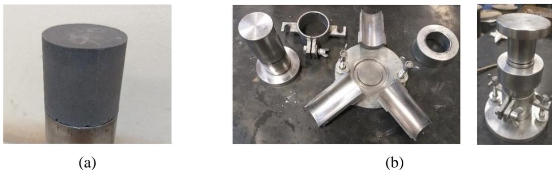
Figura 4.11 - a) Aspecto dos corpos de prova; logo após a moldagem; b) molde tripartido
