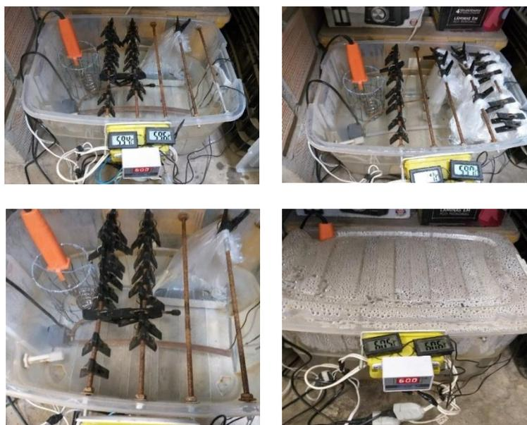
Figura 4.13 - Tanque de cura térmica
