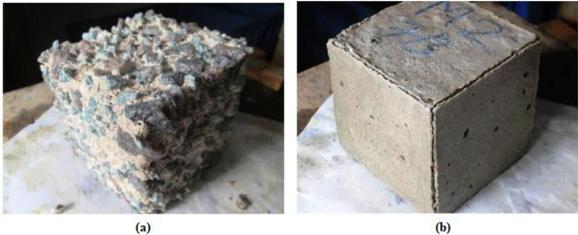
Figura 2.43 - Aparência dos corpos de prova após 120 dias de exposição ao  $H_2SO_4$  ( $pH = 1$ ): a) concreto de cimento Portland; b) concreto álcali-ativado de escória
