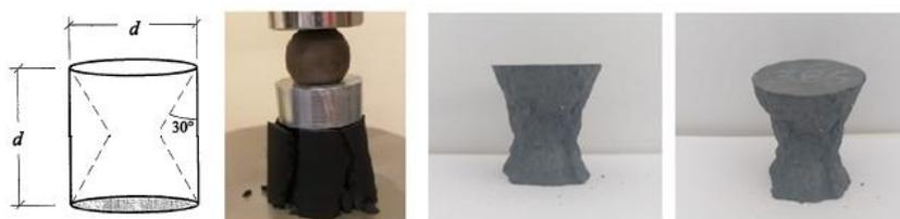
Figura 5.2 - Modo de ruptura dos corpos de prova submetidos a UCS
