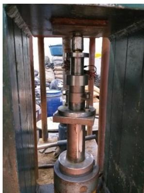
Figura 4.12 - Moldagem dos corpos de prova por compactação estática
