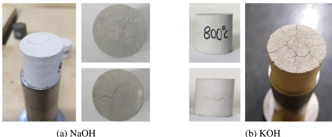
Figura 5.61 - Fissuras apresentadas após exposição a 800°C
