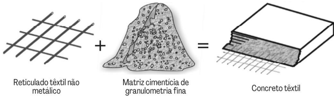
Figura 1 – Composição do concreto têxtil (Fonte: Adaptado de AJDUKIEWICZ et al., 2012)
