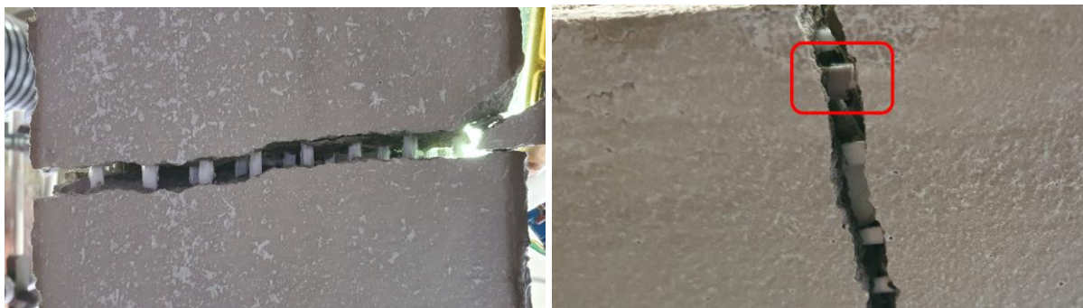
Figura 128 – Ruptura por falha na ancoragem do têxtil no interior da matriz nas vigas V1 (a) e V2 (b) (Fonte: Autor)
