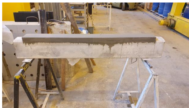
Figura 91 – Desforma das vigas dos lotes 3 e 4 (Fonte: Autor)
