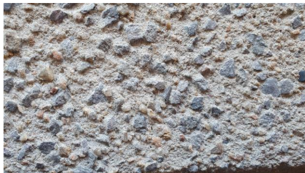
Figura 47 – Rugosidade promovida ao substrato (Fonte: Autor)
