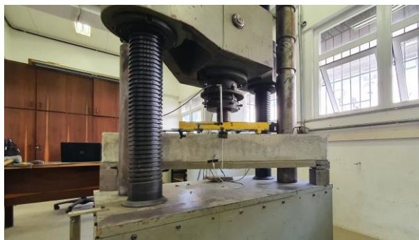
Figura 93 – Representação real do ensaio de flexão a 4 pontos (Fonte: Autor)
