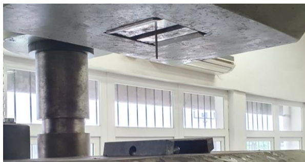
Figura 105 – Ruptura da barra (Fonte: Autor)
