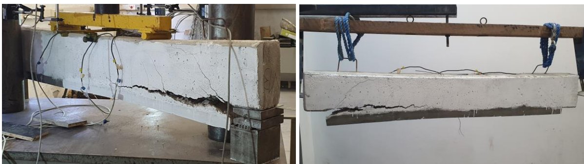
Figura 130 – Ruptura por falta de ancoragem do reforço na viga V13 (Fonte: Autor)
