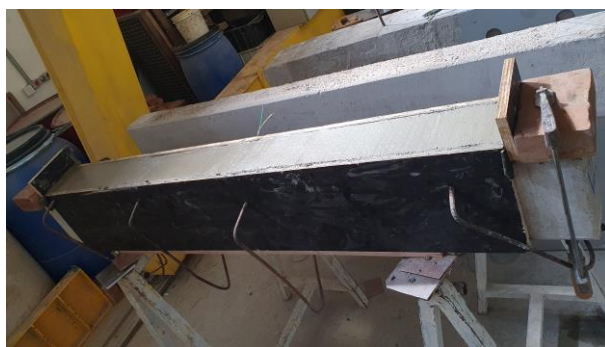
Figura 80 – Viga reforçada com três camadas de argamassa industrializada (Fonte: Autor)
