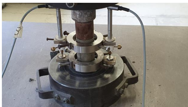
Figura 110 – Ensaio de módulo de elasticidade estático das argamassas (Fonte: Autor)
