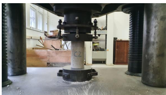
Figura 100 – Ensaio de resistência à compressão do concreto (Fonte: Autor)
