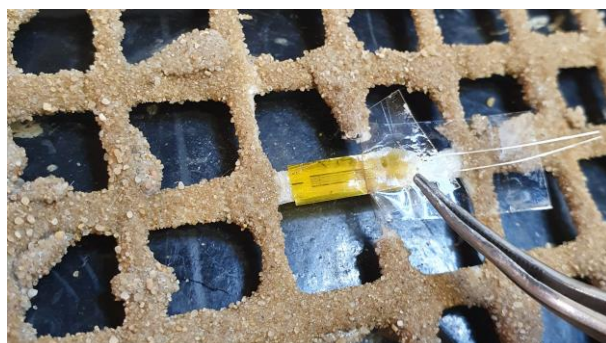
Figura 71 – Fixação do extensômetro na superfície do têxtil (Fonte: Autor)
