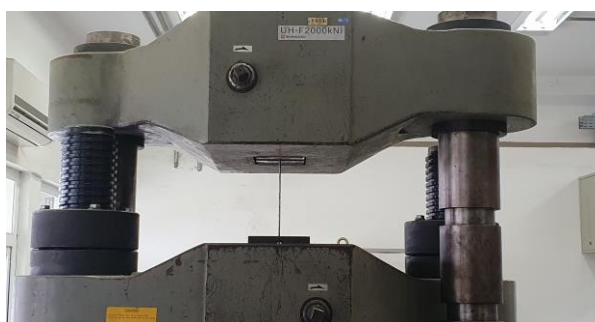
Figura 104 – Ensaio de resistência à tração do aço (Fonte: Autor)
