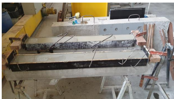
Figura 90 – Vigas reforçadas com a matriz autoadensável (Fonte: Autor)
