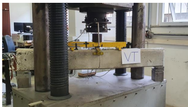
Figura 112 – Ruptura da viga testemunho (Fonte: Autor)
