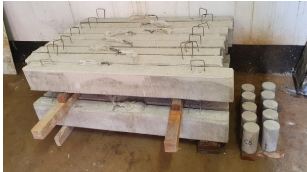
Figura 44 – Acondicionamento das vigas e dos corpos de prova (Fonte: Autor)
