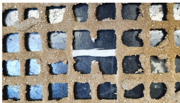
Figura 70 – Rompimento do fio de trama para fixação do extensômetro (Fonte: Autor)
