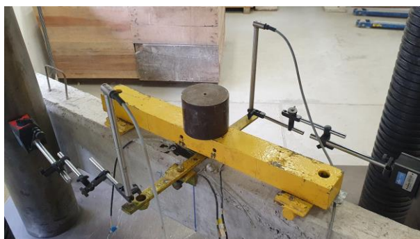
Figura 95 – Sistema de aplicação de carga e posicionamento dos LVDTs (Fonte: Autor)
