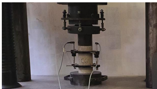
Figura 101 – Ensaio de módulo de elasticidade estático do concreto (Fonte: Autor)
