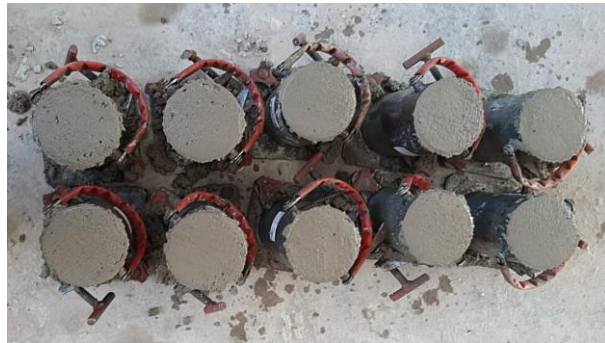
Figura 42 – Moldagem dos corpos de prova cilíndricos (Fonte: Autor)
