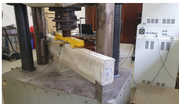
Figura 94 – Viga posicionada para ensaio (Fonte: Autor)
