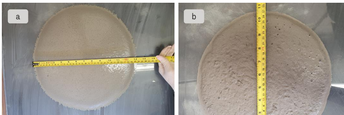
Figura 107 – Matrizes autoadensáveis com instabilidade (Fonte: Autor)
