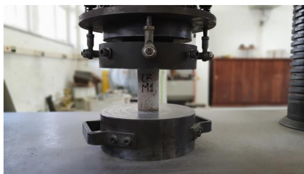
Figura 109 – Ensaio de resistência à compressão das argamassas de reforço (Fonte: Autor)
