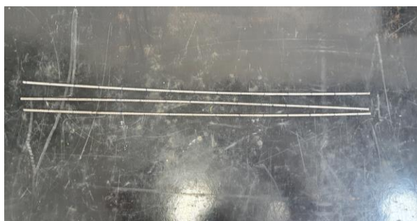
Figura 103 – Barras de aço CA-60 ensaiadas à tração (Fonte: Autor)
