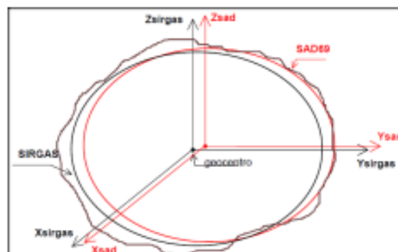
Figura 3.13 – Diferenças na definição de referenciais: local (SAD-69), e geocêntricos (WGS-84, ITRFyy e SIRGAS). Extraído de (PEREIRA, K.D., LOBIANCO, M.C.B, COSTA,S.M.A.,2004)
