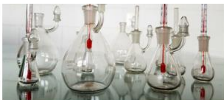
Figura A Picnômetros com termômetro. Um picnômetro é um recipiente de vidro construído para que o volume de um fluido não se altere. Retirado de http://www.splabor.com.br/blog/vidraria/aprendendo-mais-picnometro-saiba-como-utiliza-lo/
