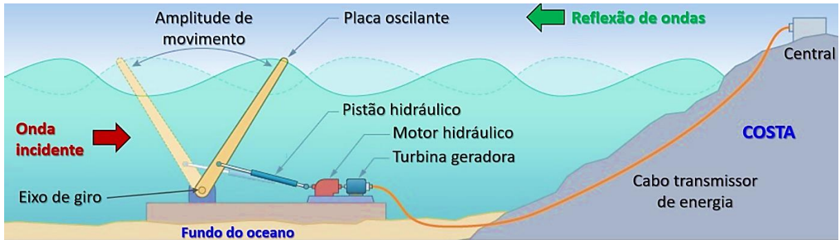
Figura 2.24 – Princípio de funcionamento de um OWSC (fonte: adaptado de NATIONAL RENEWABLE ENERGY LABORATORY, 2018)
