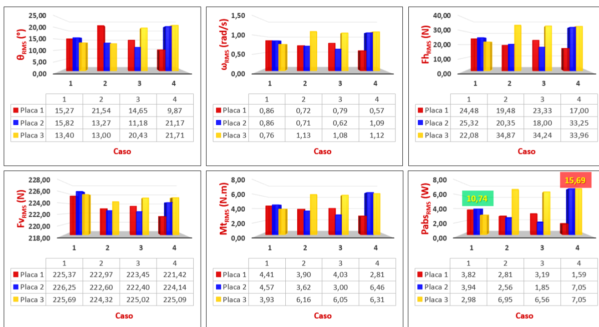
Figura 4.37 Valores RMS da amplitude angular, velocidade angular, força horizontal, força vertical, momento de excitação e potência captada, considerando a ação de ondas estacionárias sobre um sistema composto por três placas em série.
