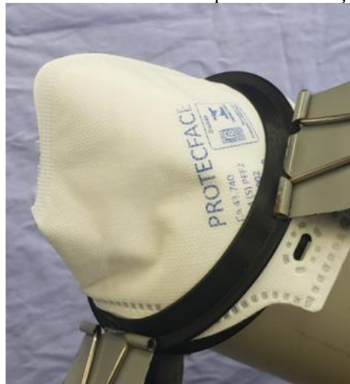
Figura 3 – Foto do dispositivo para medida indireta da da eficiência de filtração da máscara PFF2 com aplicação de diferentes fluxos de ar comprimido e medição da pressão gerada
