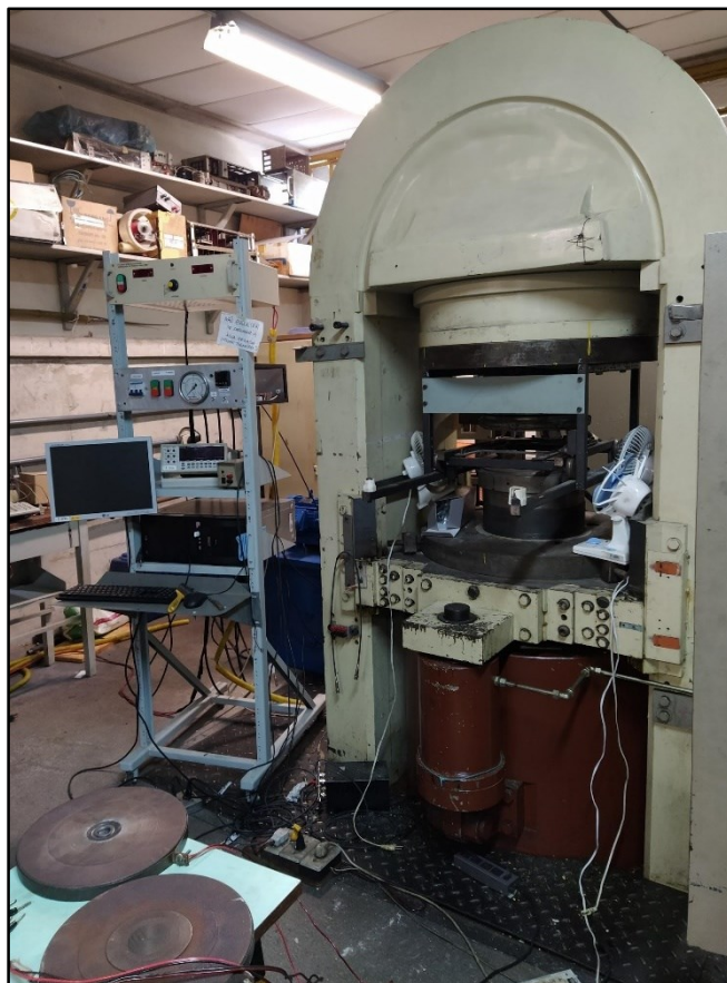
Figura 11: Prensa hidráulica utilizada nos experimentos. No canto inferior esquerdo estão as câmaras de perfil toroidal.
