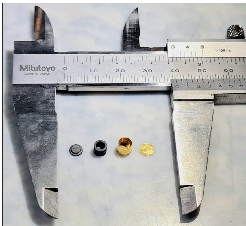
Figura 6: Componentes da dupla-cápsula de grafita e ouro. A amostra em pó é inserida no interior da cápsula de grafita, que por sua vez é inserida na cápsula de ouro e selada.
