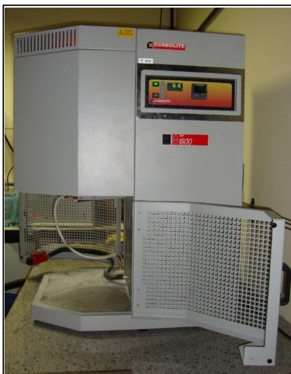
Figura 10: Forno Carbolite® BFL 18/3 do LAPMA, utilizado na decarbonatação.
