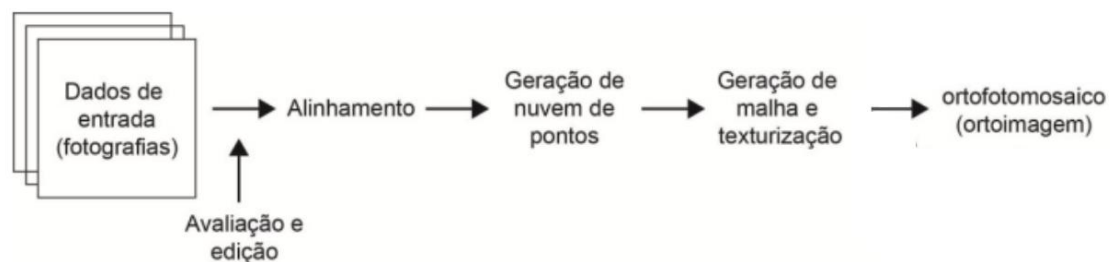
Figura 22 Algoritmo para geração de ortofotomosaicos a partir das fotografias (modificado de MICHEL, 2021).
