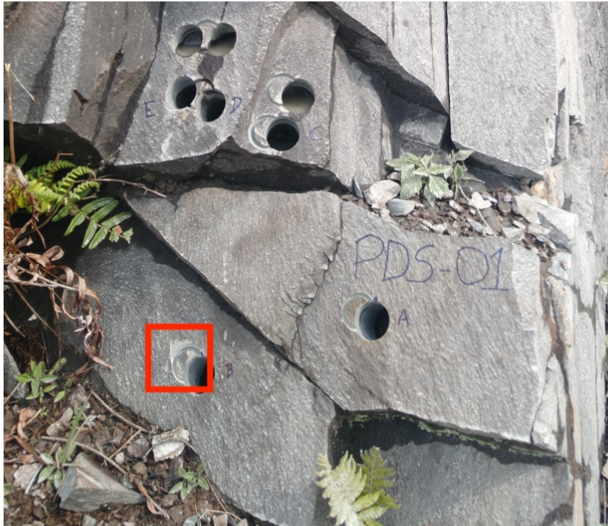
Figura 6. Marcação de 1 cm de profundidade feita inicialmente (em vermelho). Perfuração concluída, espaço onde foi retirado o cilindro (em amarelo).
