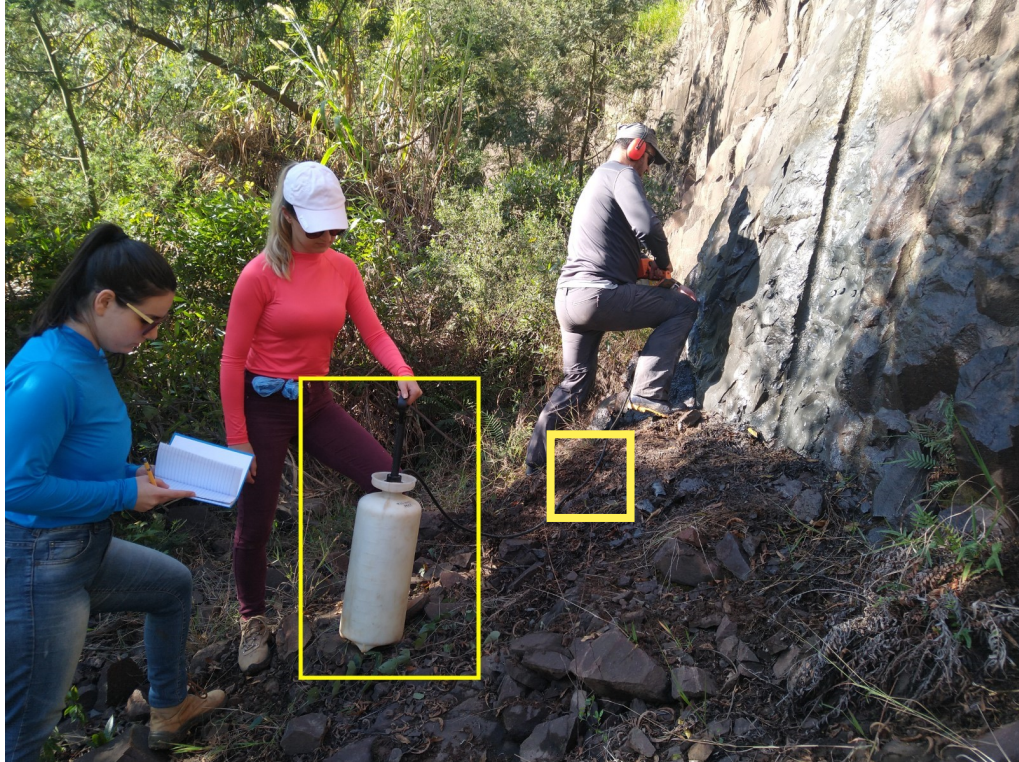
Figura 5. Perfuração dos cilindros, com destaque em amarelo para a bomba de água contendo uma mistura de água e óleo solúvel para a refrigeração e diminuição do atrito durante a perfuração.
