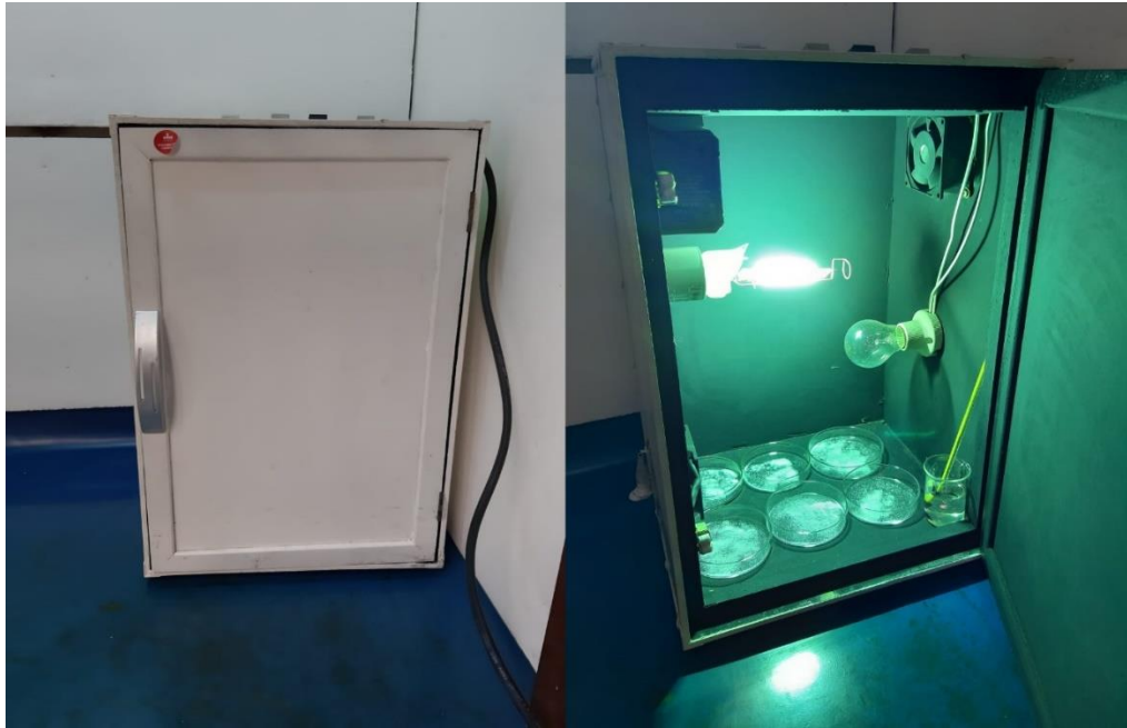
Figura 5: Câmara de degradação acelerada empregada no trabalho.
