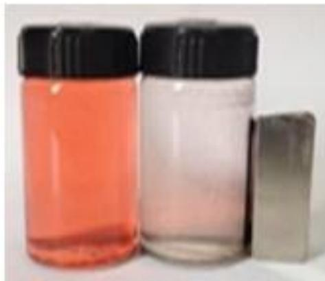
Figura 3.16. Adsorção do corante Vermelho Congo com nanopartículas de CoFe<sub>2</sub>O<sub>4</sub>, com posterior separação magnética do adsorvente. Adaptado de [5].
