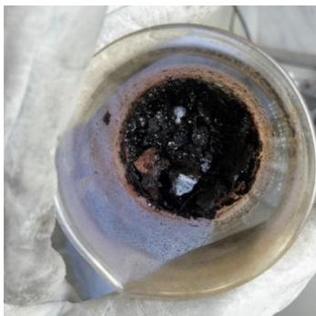
Figura 4.2. Xerogel obtido após a secagem do gel a 110°C por 24 h.
