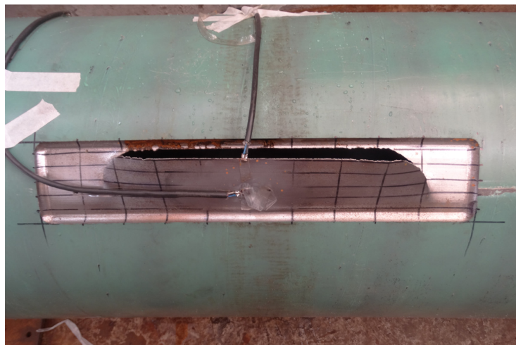
Figura 62 - Local de Ruptura do ensaio hidrostático de explosão - T1870PE05
