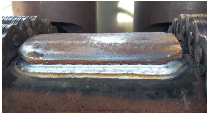
Figura 44 - Passe de enchimento realizado com o processo MAG
