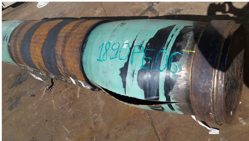
Figura 69 - Local de Ruptura do ensaio hidrostático de explosão - T1890PE06
