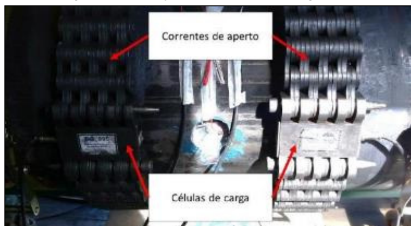
Figura 40 - Fixação das células de carga
