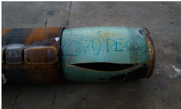
Figura 66 - Local de Ruptura do ensaio hidrostático de explosão - T1870PE02
