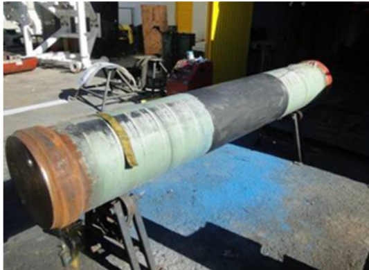
Figura 29 - Aplicação de lubrificante (Molykote) nas superfícies do tubo e calhas
