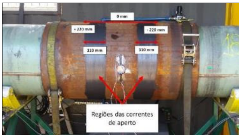
Figura 36 - Área lubrificada pelo Molykote
