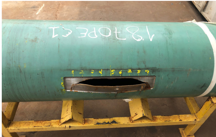
Figura 60 - Local de Ruptura do ensaio hidrostático de explosão - T1870PE01
