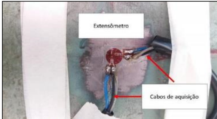
Figura 35 - Extensômetro da região externa ao reparo
